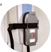
El Chamber Adapter permite utilizar cámaras de ionización con el Piranha. El adaptador está diseñado principalmente para el uso en mamografías y TC pero también puede utilizarse para otras aplicaciones.
