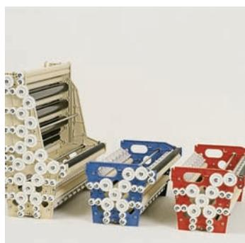
La combinación especial de los rodillos y el control electrónico de temperatura aseguran un secado adecuado de las películas por aire caliente.
